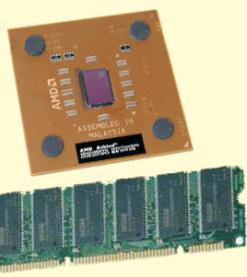
**Централният процесор** (Central Processing Unit - CPU) е устройството, което в най-голяма степен определя бързодействието на една компютърна система.
